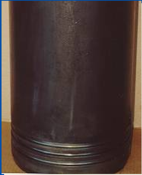
Pas de cavitation Concentré Havoline XL Corrosion Inhibitor au bout de deux ans
