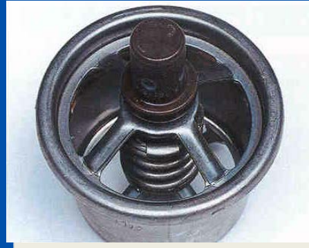
Pas d'écaillage ou de dépôts après 643 000km avec un liquide de refroidissement longue durée
